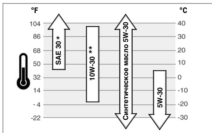
\* Использование масла SAE 30 при температурах ниже 40°F (4°C) приведет к затрудненному запуску двигателя.
